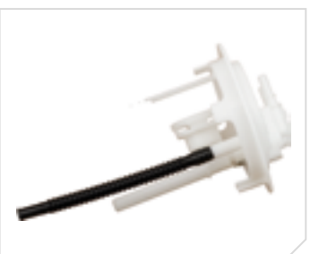
مجموعه هد پمپ بنزین صفر درجه 405
